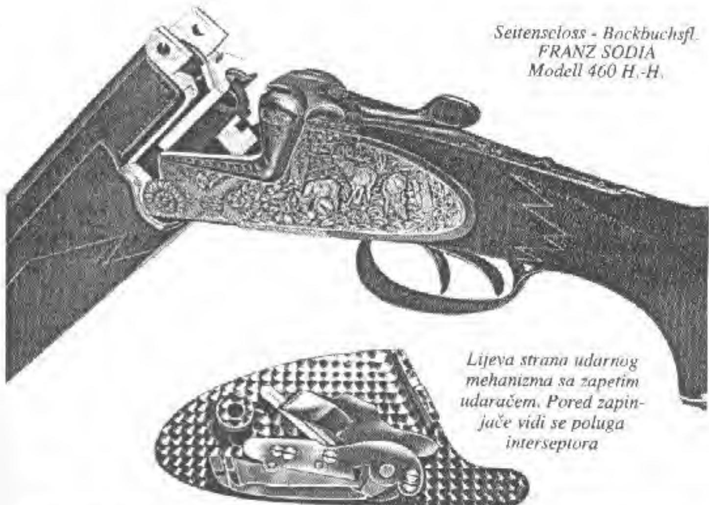
*Lijeva strana udarnog mehanizma sa zapetim udaračem. Pored zapinjuće vidi se poluga interseptora*
